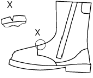
a) Sayada derin çatlaklar
